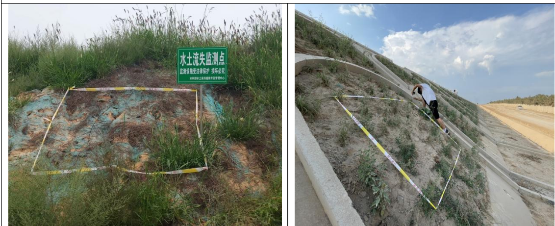
朔州南制梁场表土堆放场测钎监测点
